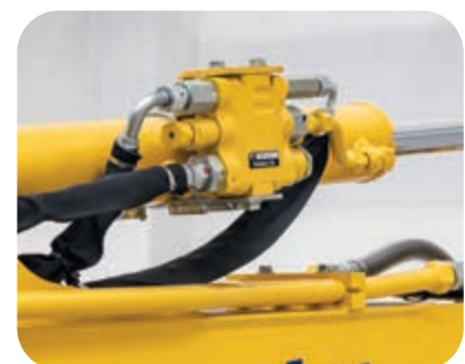
Slangbreukbeveiliging op hef- en armcilinders
